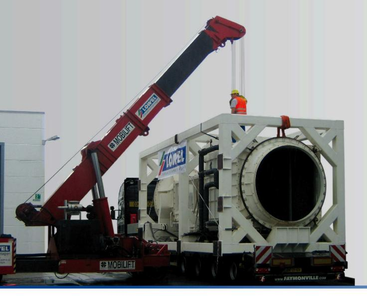
Mit unseren beiden Mobiliften sind wir in der Lage, jeweils bis zu 50 Tonnen schwere Lasten anzuheben, zu verfahren und wieder abzusetzen und das mit höchster Präzision und bei geringem Platzbedarf, innerhalb und außerhalb von Hallen.
