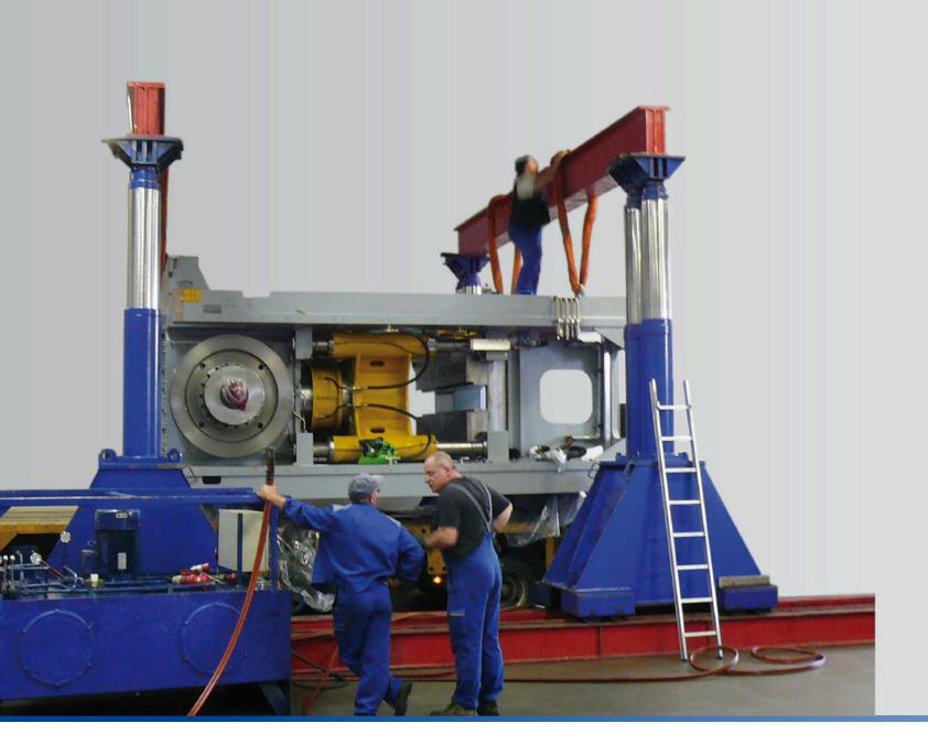
Montage einer Presse mit einem Eigengewicht von 75to. zur Herstellung von Gehäuse für Haushaltsgeräte. Die Presse wurde mittels Hubportalen vom Lkw entladen und mit einem Transportanhänger an ihren Bestimmungsort gebracht.
